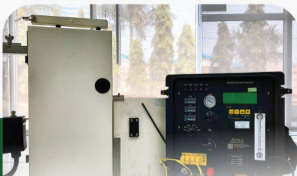
Full set Pengambilan Contoh Uji Emisi Sumber Tidak Bergerak
